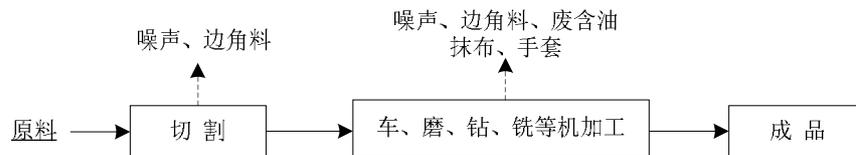
图 2 项目模具生产工艺流程及产污环节示意图
