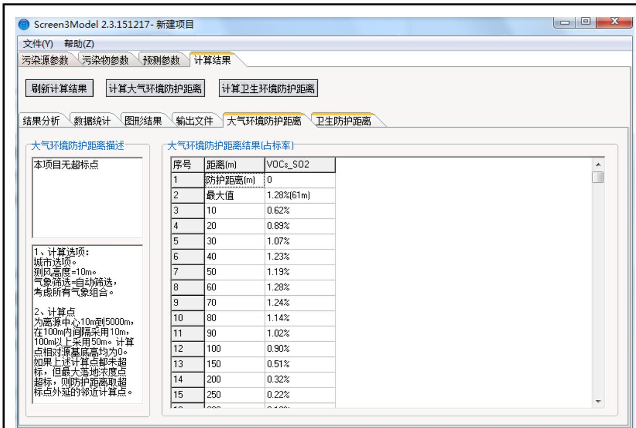
图7-2 丝印烘干车间无组织VOCs排放大气防护距离计算截图
