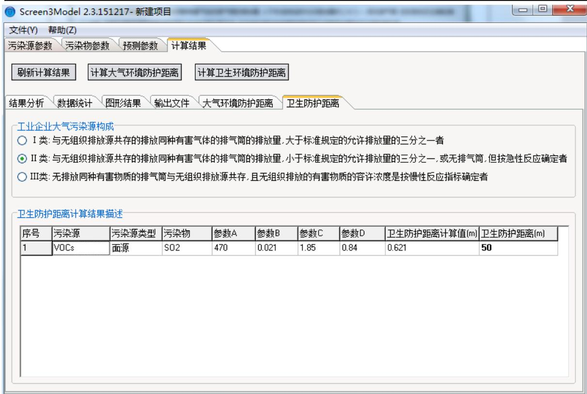
图7-4 丝印烘干车间无组织VOCs排放卫生防护距离计算截图
