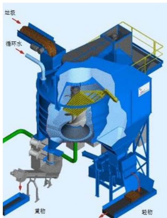
图 4.1-5 分选制浆一体机示意图
