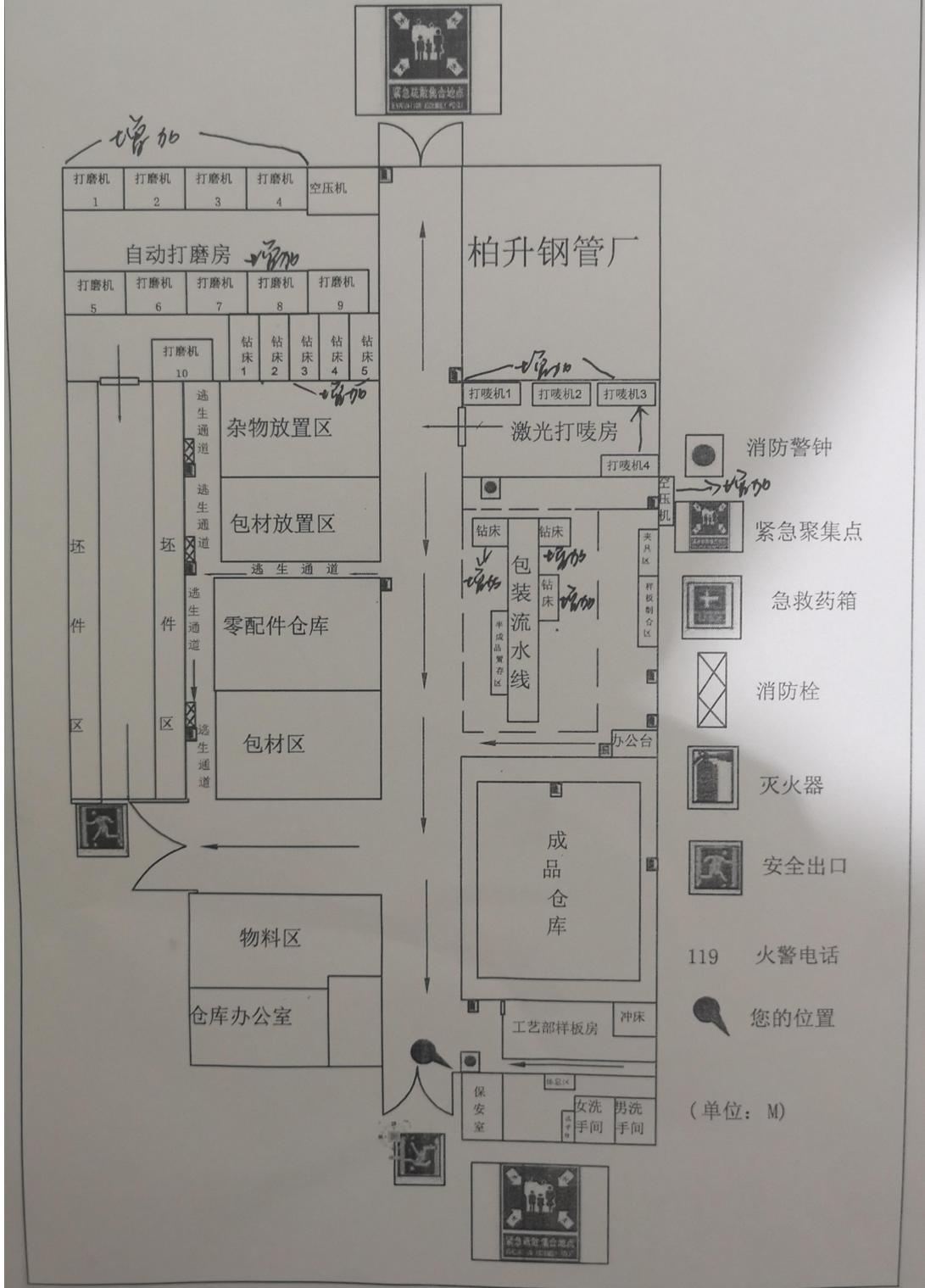
附图 4 项目平面布局图 (打砂车间)
