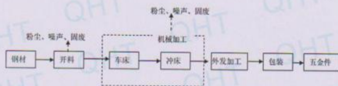
图 3-4 项目五金件生产工艺流程及产污环节示意图
