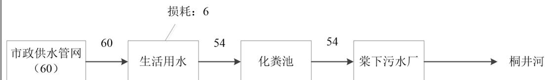
图 1-1 项目全厂水平衡图（单位：t/a）
