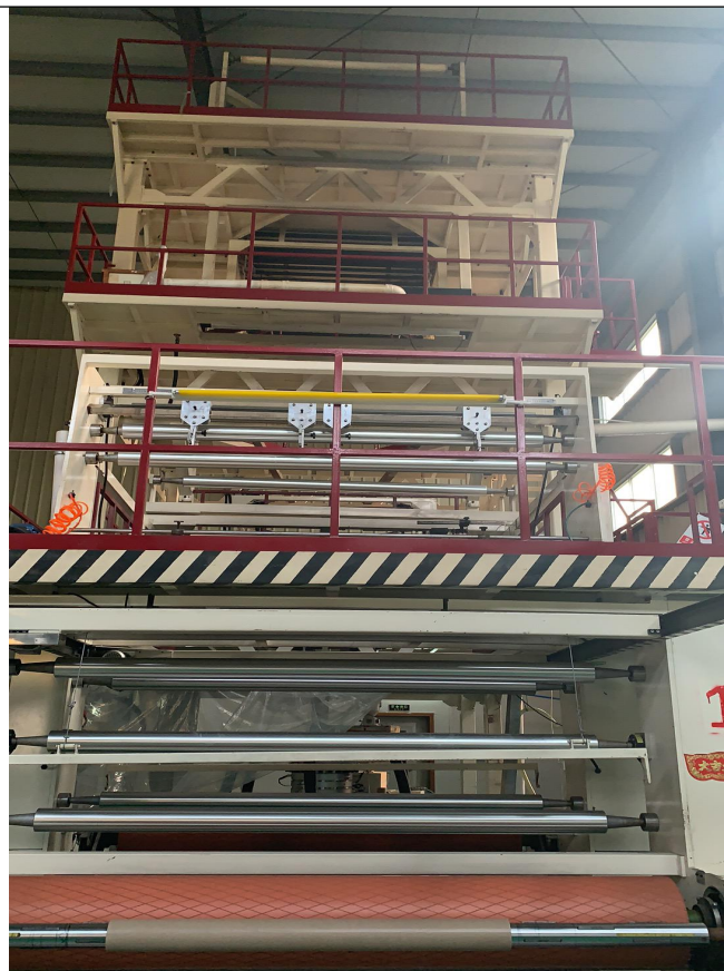
1#三层共挤PE膜生产线（SJ65/75/65-2200）
