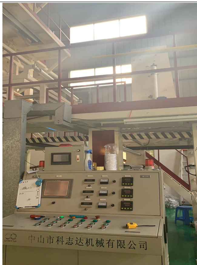
2#三层共挤PE膜生产线（SJ55/55/55-2000）
