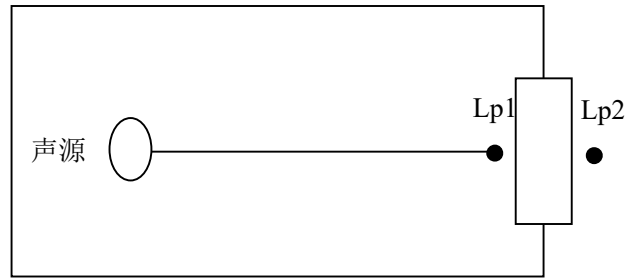
图8-1 室内声源等效为室外声源图例图
