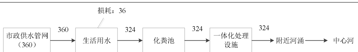
图 1 项目全厂水平衡图（单位：m³/a）
