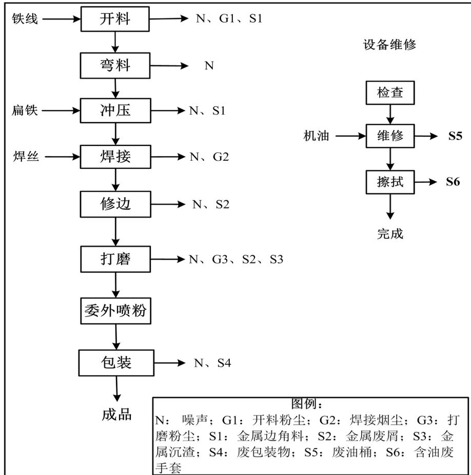
图 1 工艺流程图及产污环节图
