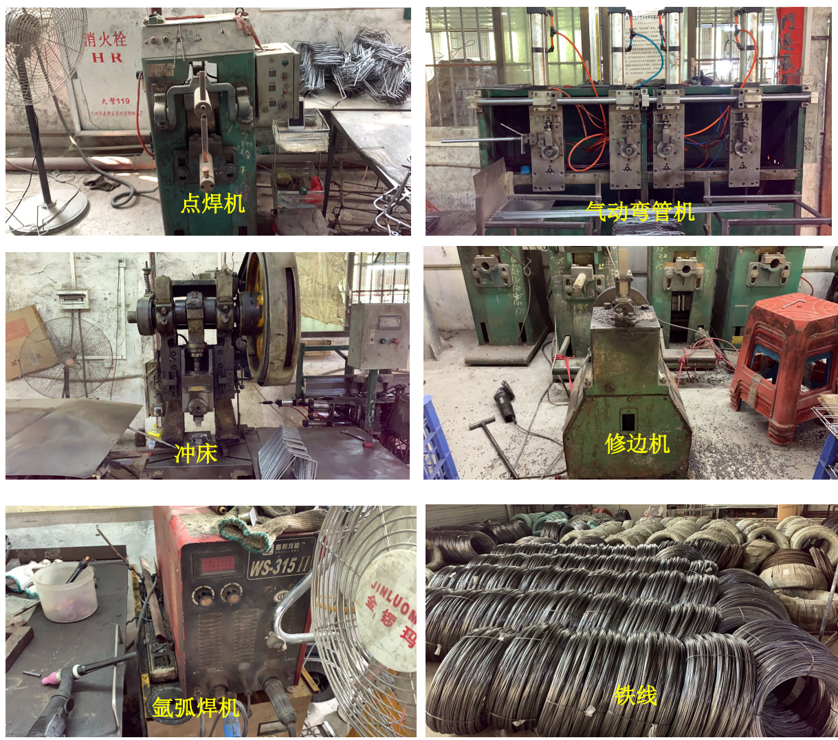
附图 11 项目现场照片
