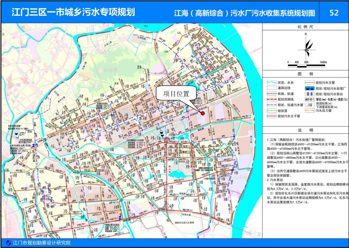
附图 10 江海污水厂管网图
