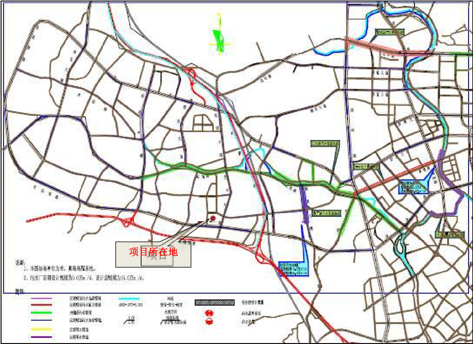
附图 11 杜阮污水处理厂纳污管网范围
