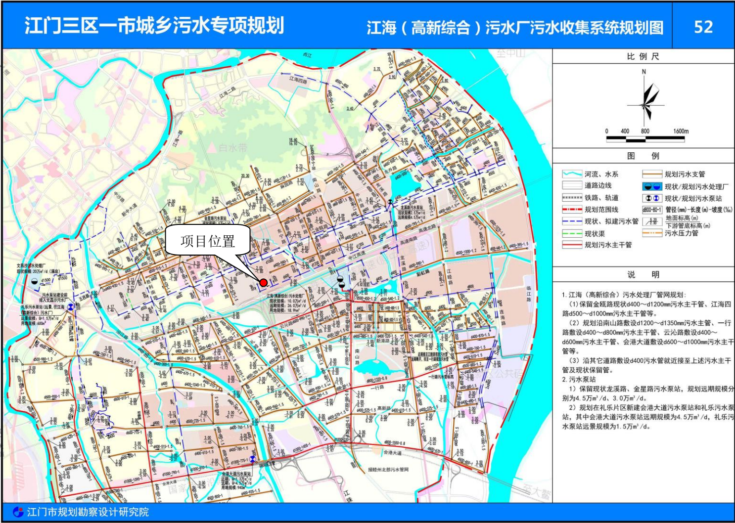
附图 10 江海污水厂管网图
