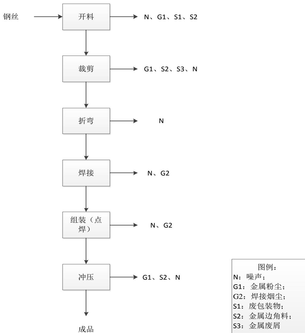
图 1 工艺流程图及产污环节图
