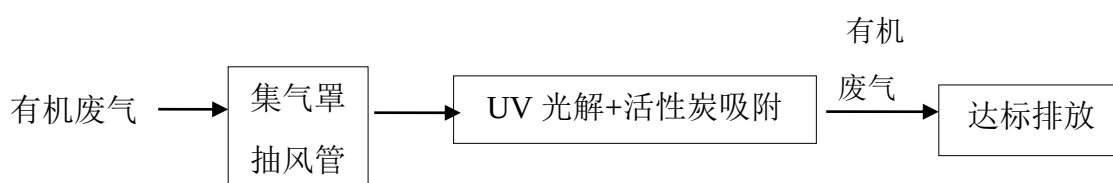
图 7-8 集气罩收集 UV 光解+活性炭吸附装置处理工艺流程图
