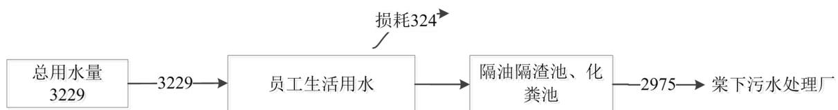
图 1-1 原项目水平衡图 (m<sup>3</sup>/a)
