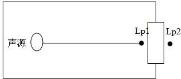
图7-2 室内声源等效为室外声源图例
