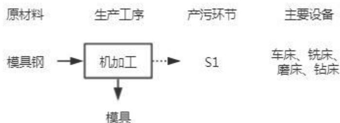
图 5-1 模具生产工艺流程
