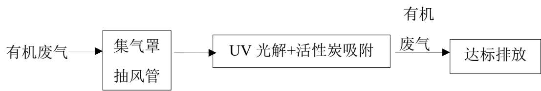
图 7-7 集气罩收集 UV 光解+活性炭吸附装置处理工艺流程图
