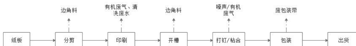
图 5-1 项目生产工艺流程及产污环节图
