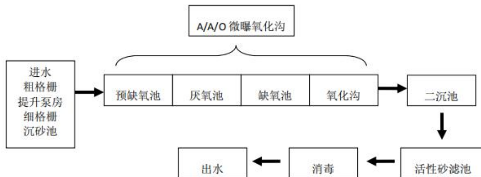
图 7-1 新美污水处理厂水处理工艺流程图
