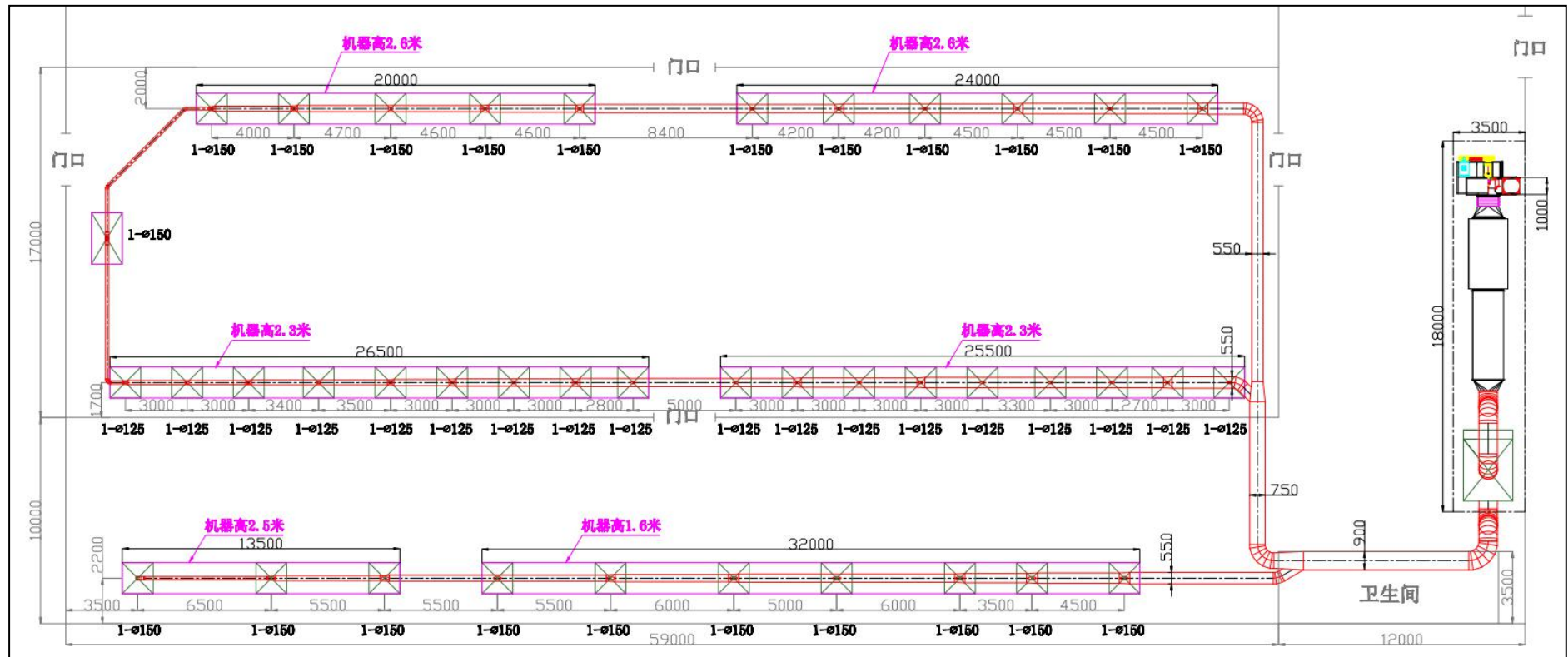
图 2.1-8 废气收集和输送管网设计图
