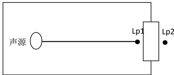
图8-1 室内声源等效为室外声源图例图
