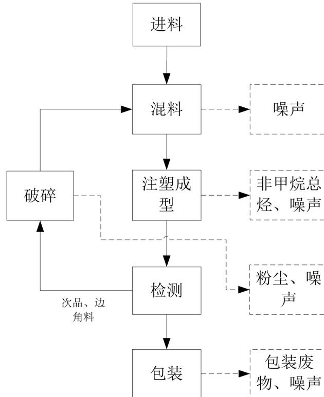
图2-1 本项目工艺流程图
