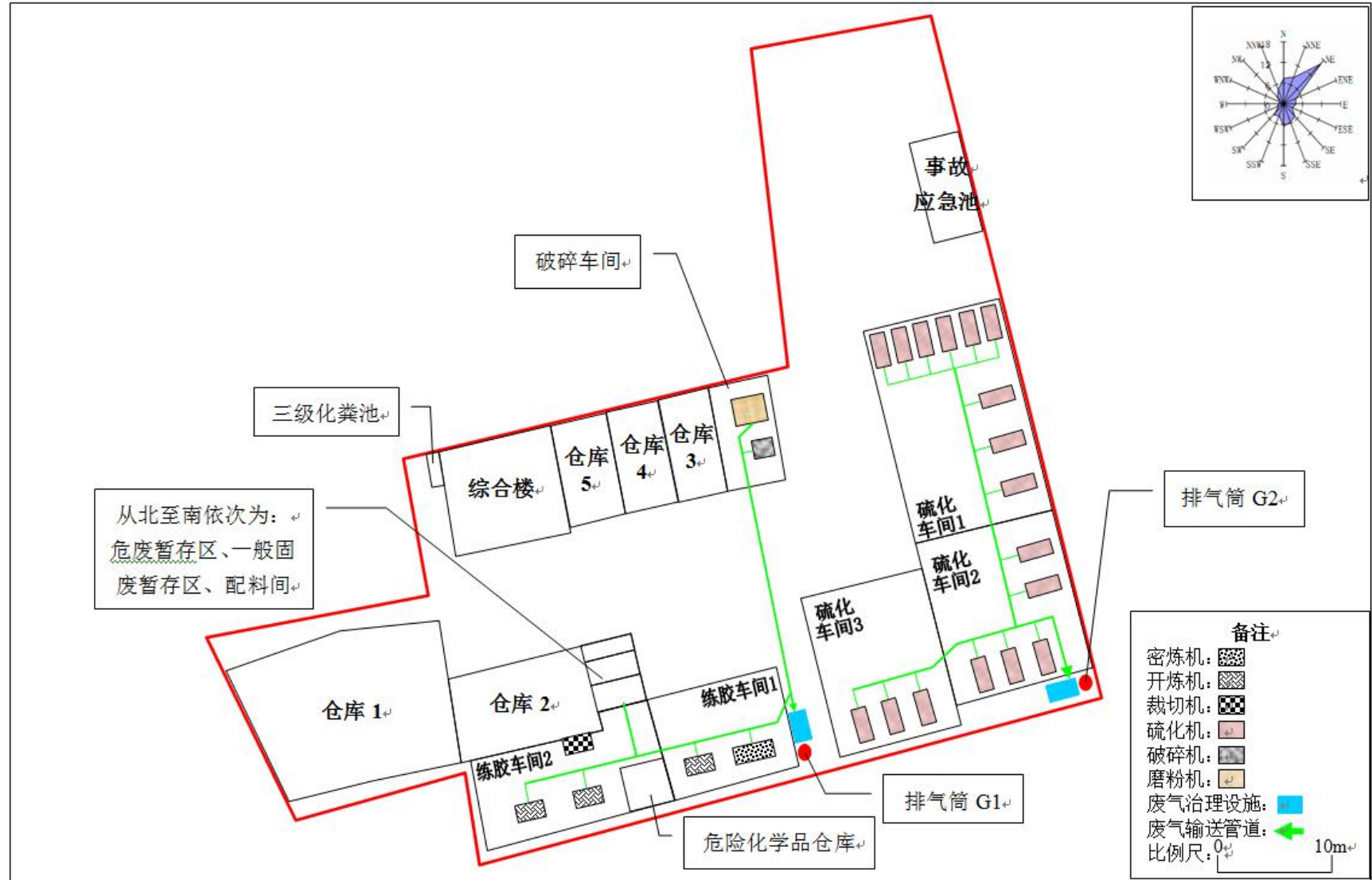
图 2.1-7 整改后设备平面布置及废气收集示意图
