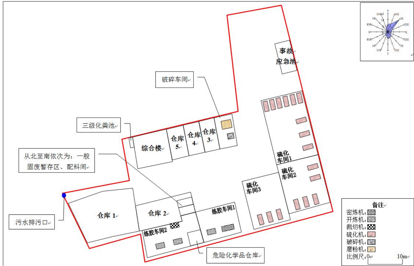
图 2.1-6 整改前设备平面布置图
