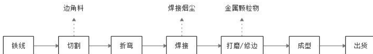
图5-1 项目生产工艺流程及产污环节图
