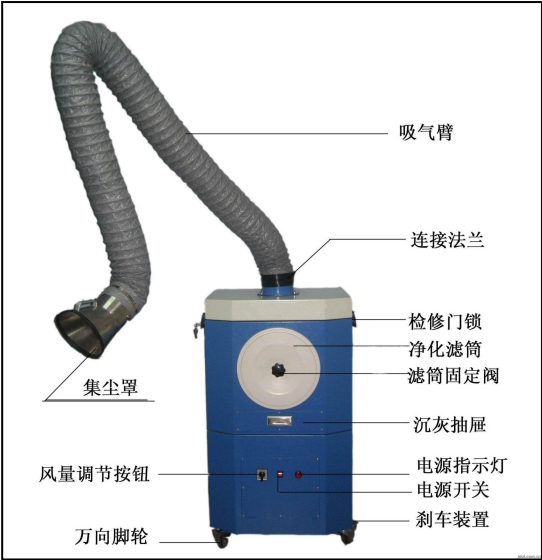
图-3 移动式焊接烟尘净化器示意图
