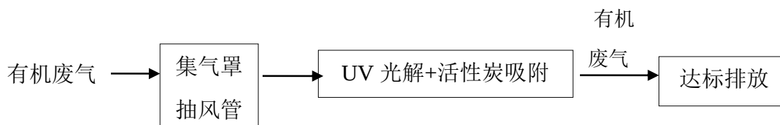
图 7-8 集气罩收集 UV 光解+活性炭吸附装置处理工艺流程图
