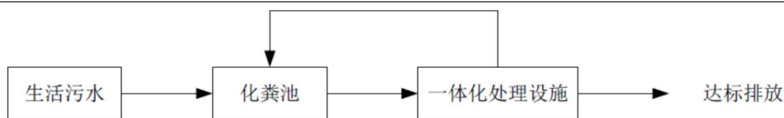
图 7-1 项目生活污水处理工艺流程
