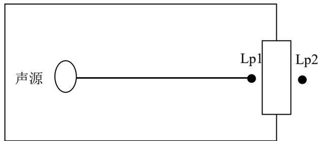
图7-1 室内声源等效为室外声源图例图
