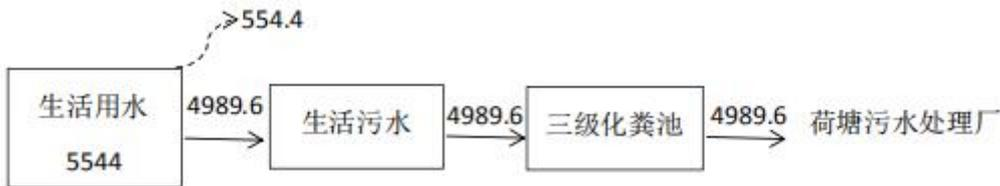
图 5-4 生活污水水平衡图 单位：m<sup>3</sup>/a
