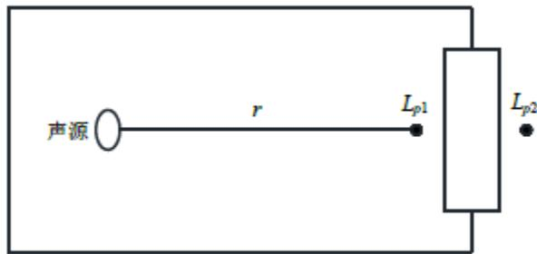
图 7-4 室内声源等效为室外声源图例
