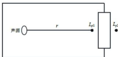
图 7-8 室内声源等效为室外声源图例
