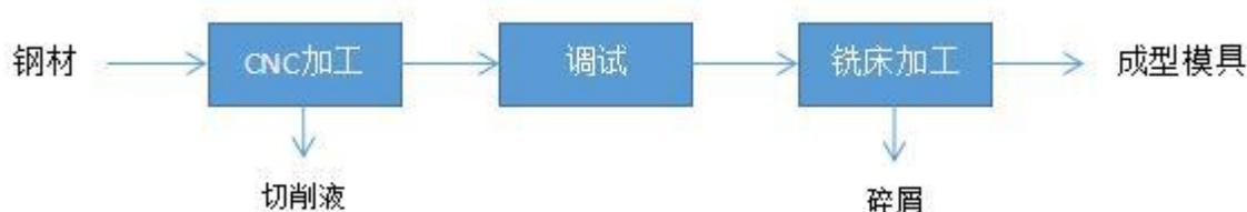
图2.5-2 模具生产工艺流程图
