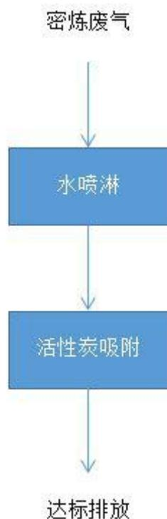
图 5.2-1 本项目拟采取的混炼废气治理工艺
