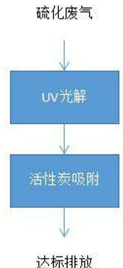
图 5.2-2 本项目拟采取的硫化废气治理工艺
