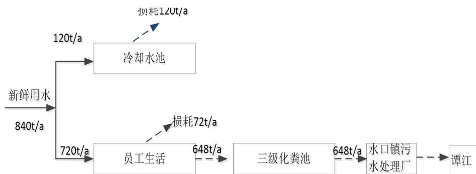
图 5-2 项目水平衡图
