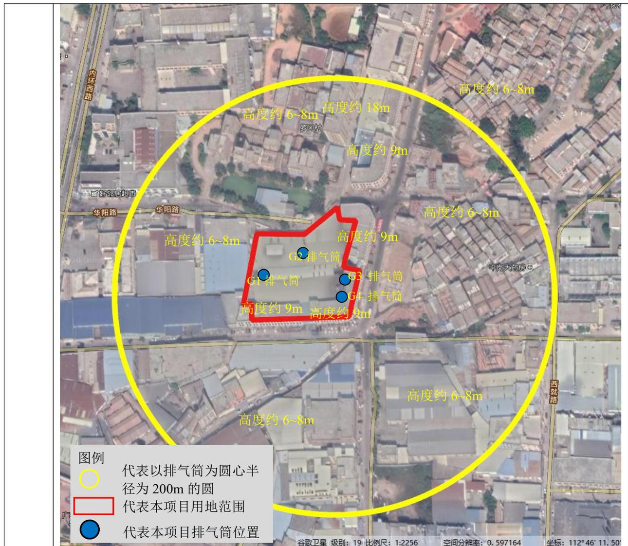
图 4-1 项目周边 200 米半径范围内建筑物高度图
