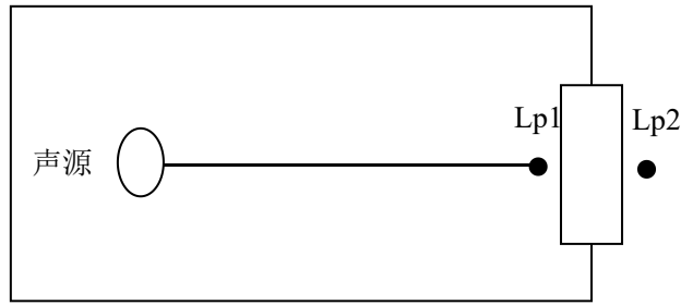
图7-2 室内声源等效为室外声源图例图
