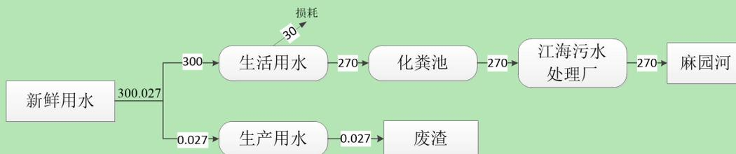
图 3.2-5 全厂给排水平衡图 (单位: t/a)
