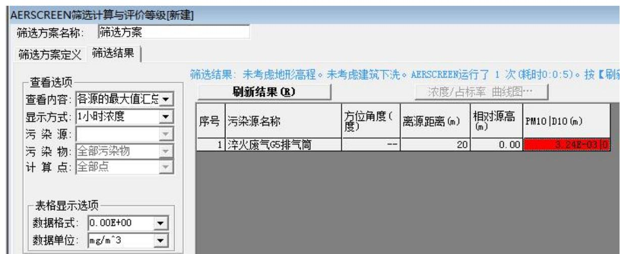
图 7-6 淬火废气 G5 排气筒大气预测结果（小时浓度）
