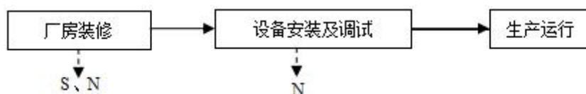
图5-1 施工期流程及产污环节示意图
