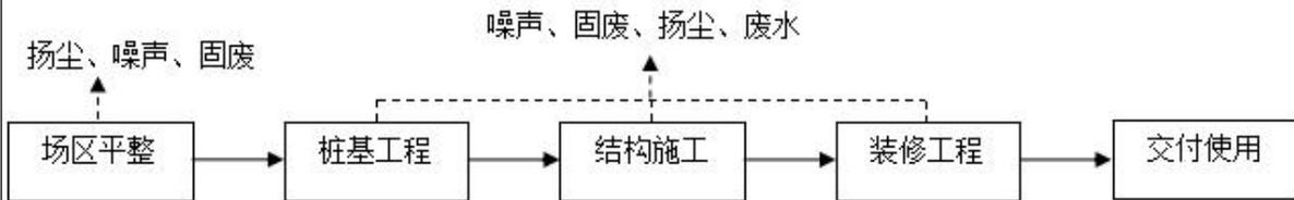
图 5-1 施工期生产工艺流程图
