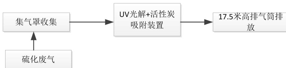
图 6.2-1 硫化废气治理工艺流程图
