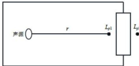
图 7-8 室内声源等效为室外声源图例
