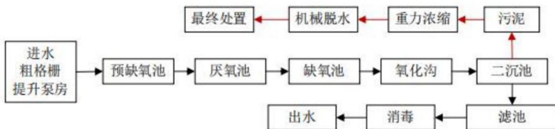
图 7-1 新美污水处理厂工艺流程图
