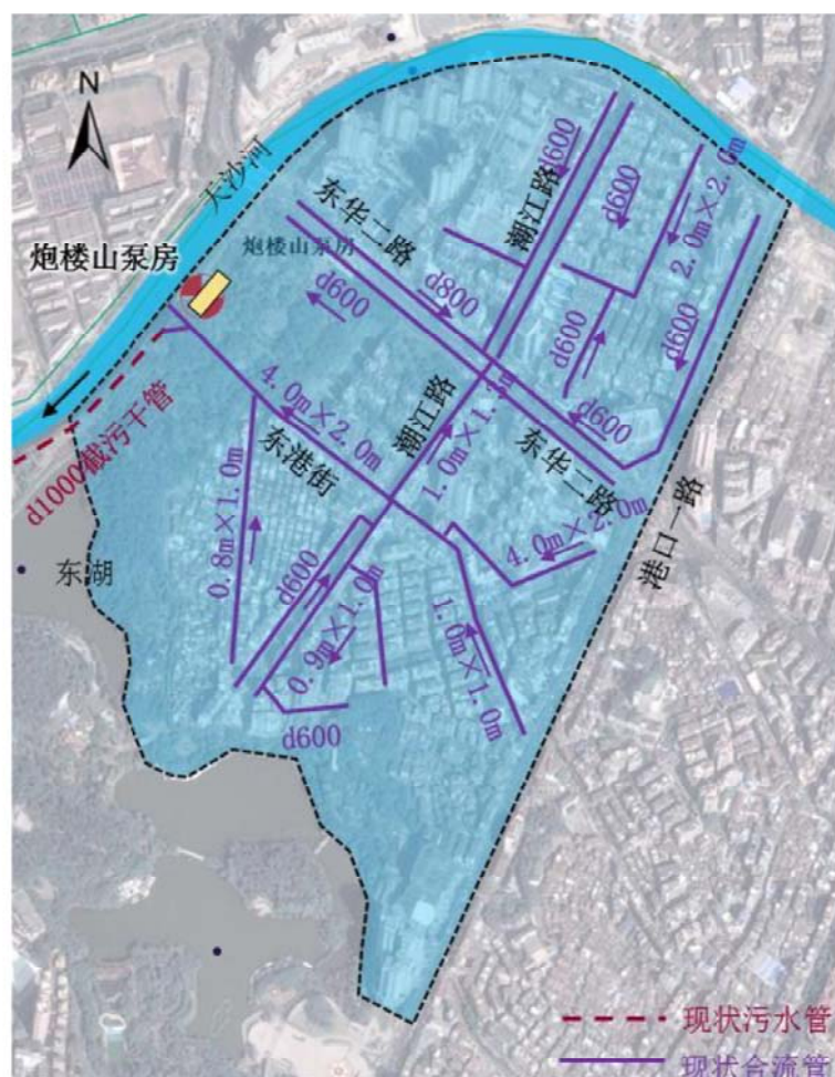
图 4.2-12 炮楼山泵房现状集水示意图
