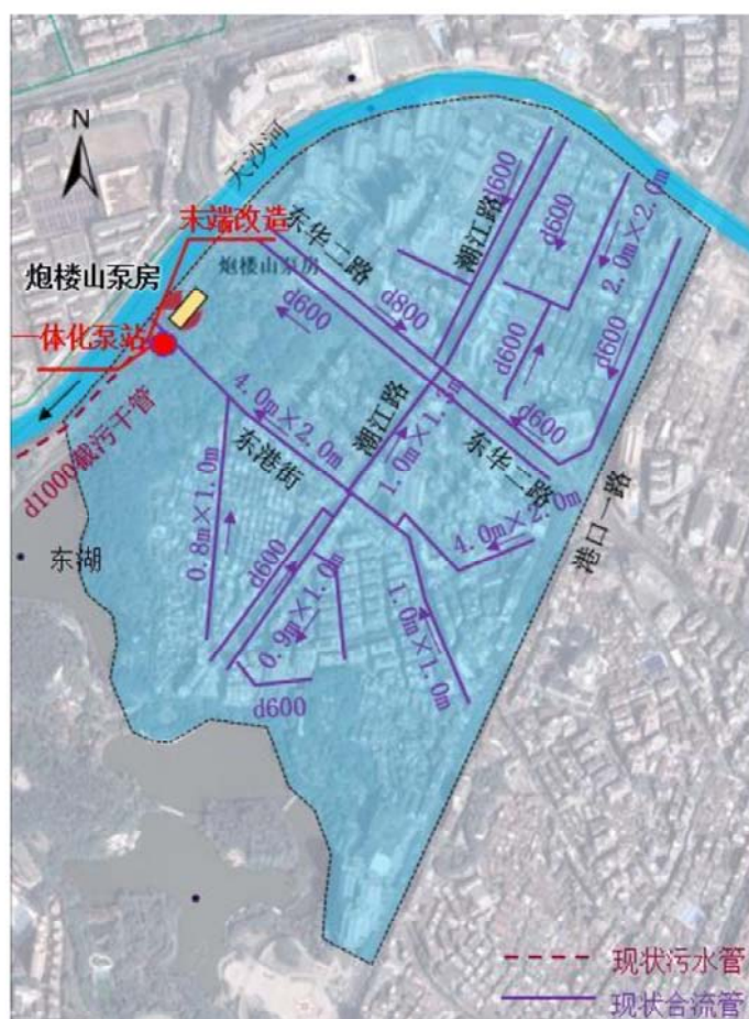
图 4.2-13 炮楼山泵房整治总体方案
