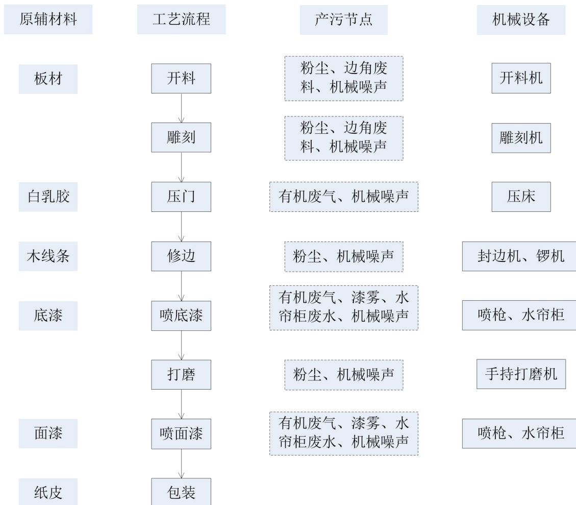
图 5-1 本项目运营期生产工艺流程图
