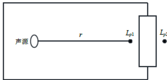
图 7-10 室内声源等效为室外声源图例
