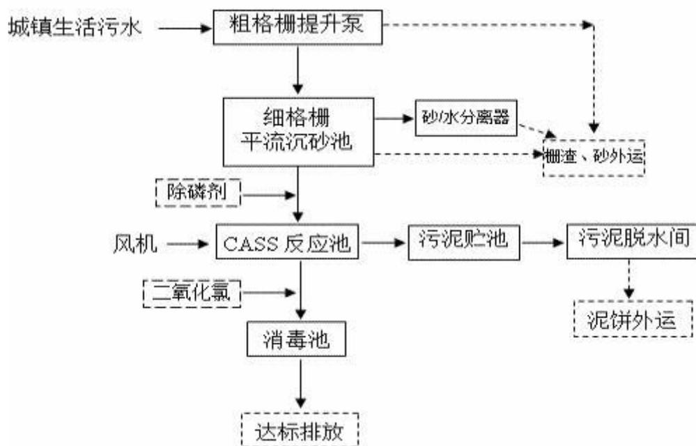
图 7-1 污水处理厂的处​​理工艺流程图
