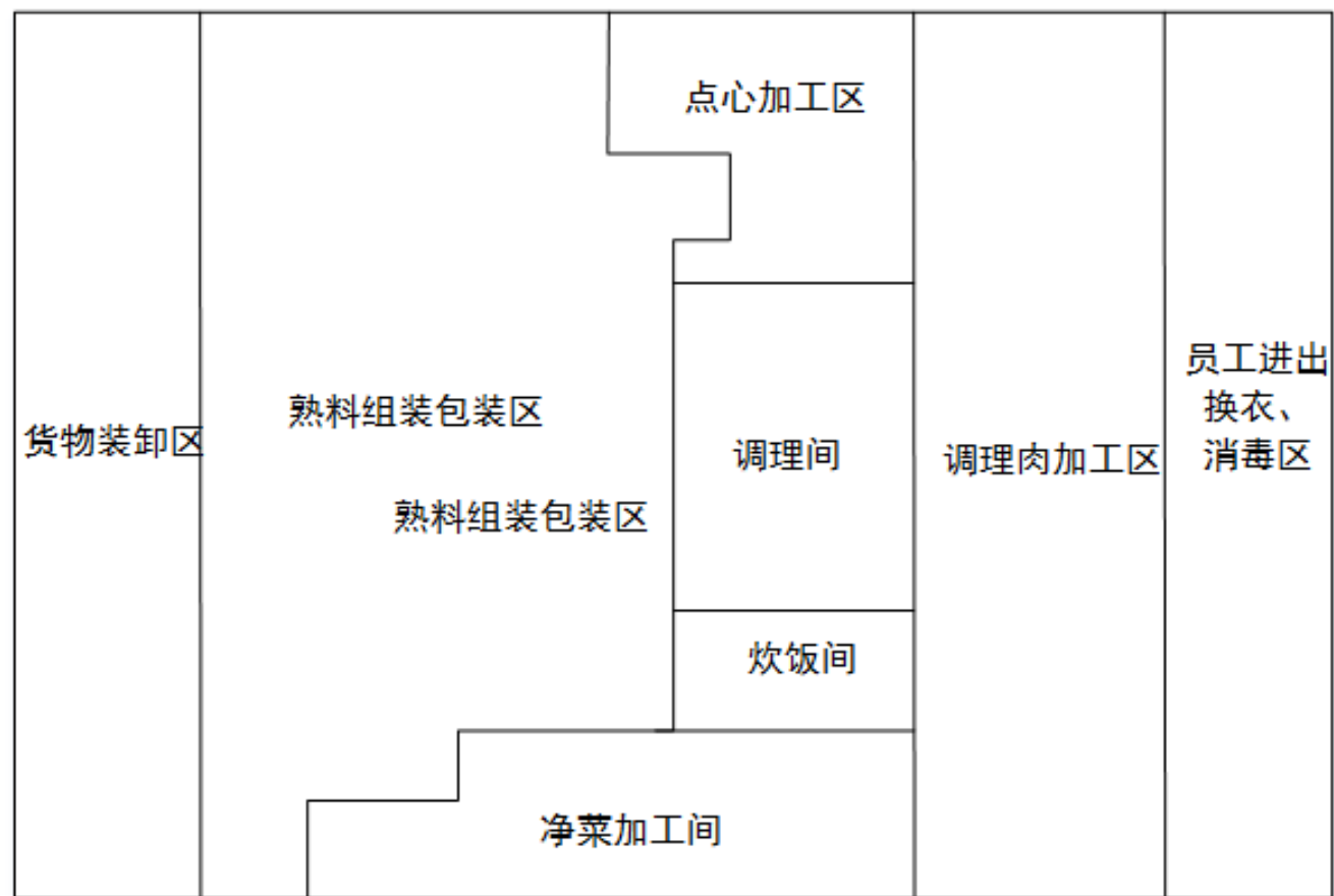
附图 4-1 快餐工厂平面布局图
