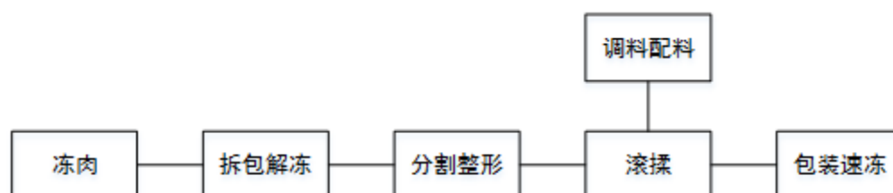
图 6-8 生肉加工工艺流程图
