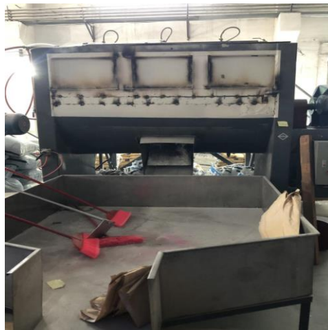
图 5-2 双层膜的混料设备
