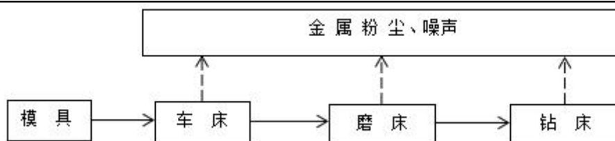
图5-2 模具维修工艺流程图
